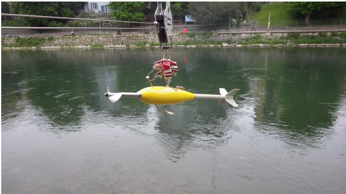
Abbildung 10: Flügelmessung an der Limmat (Jan Seibert).
